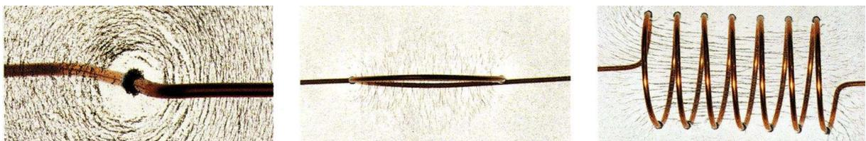
Abbildung 33: Magnetfeld um stromdurchflossenen Leiter und Spule, dargestellt durch Eisenspäne
